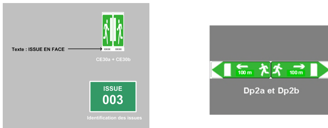
Figure 10: Signalisation des issues sur les deux piédroits
