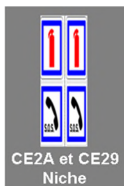
Figure 12: Signalisation des niches de sécurité
